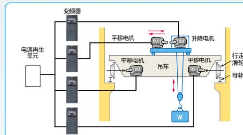
**Point** 在升降作业时采用HD额定可获得坚实的运行。平移作业时,运送对象所受到的晃动通过防摇控制功能得到抑制,从而获得高效作业。
