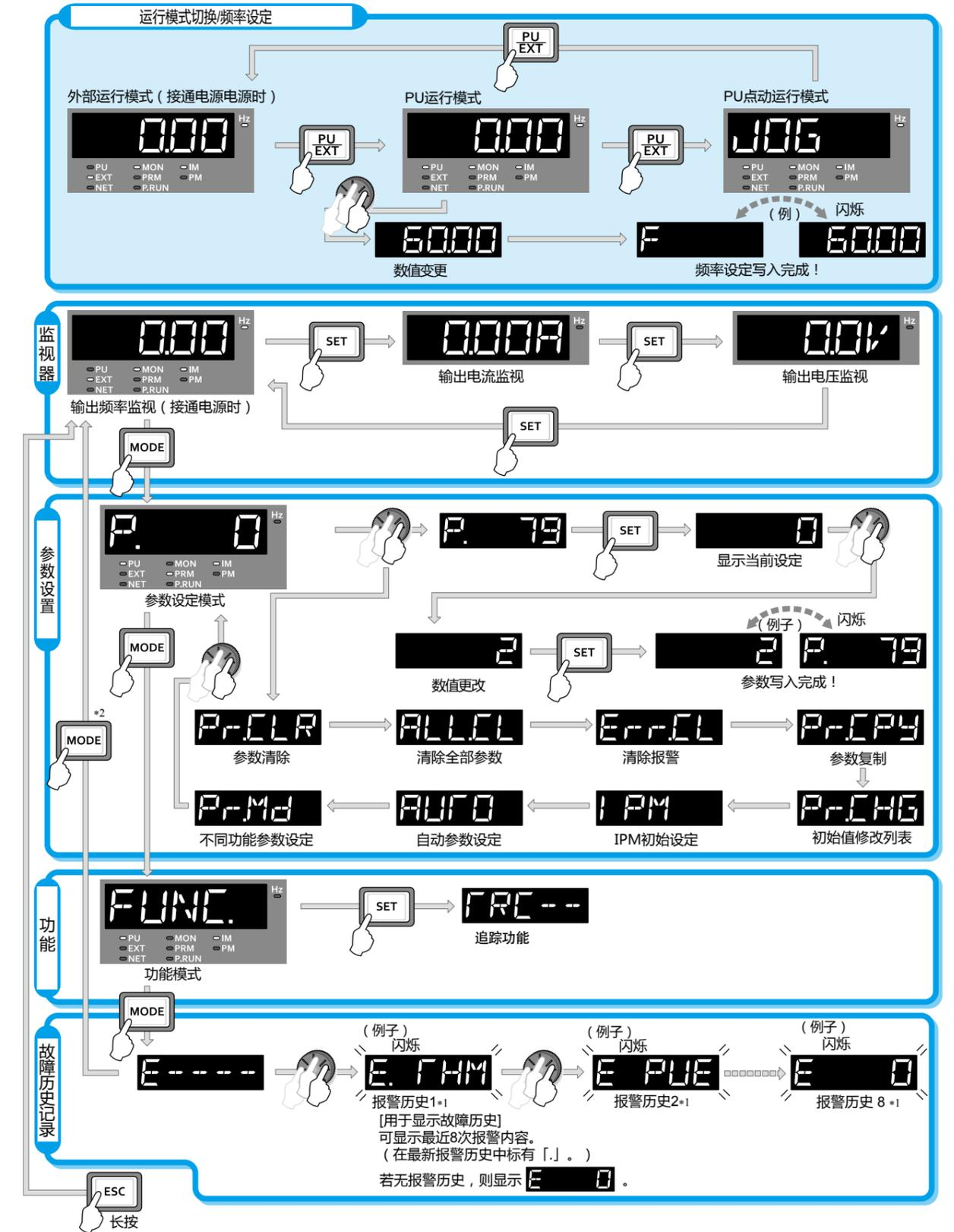
\*1 在显示一项故障时,按下 **SET** 可依照下面次序切换显示:故障时输出频率 → 输出电流 → 输出电压 → 通电时间 → 年 → 月 → 日期 → 时间。(在“时间”之后,又重新回到故障显示。)按下设置拨盘可显示故障历史数。
