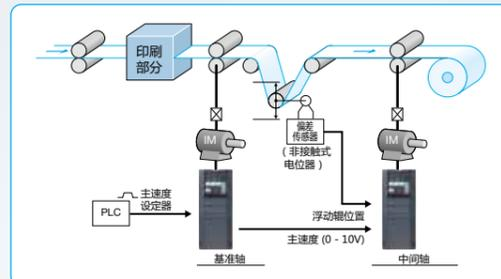
**Point** 通过速度控制与转矩控制消除松弛和不均匀的卷绕,使材料保持恒定的张力。而且通过选用最佳机械速度比的电机,来选择变频器容量。
