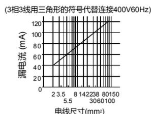
3相感应电机工频电源运行时的漏电流例
