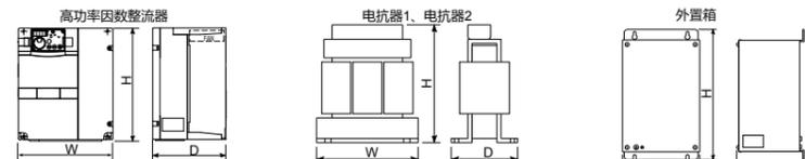
\*3 请将电抗器（FR-HCL21、22）进行水平安装。
