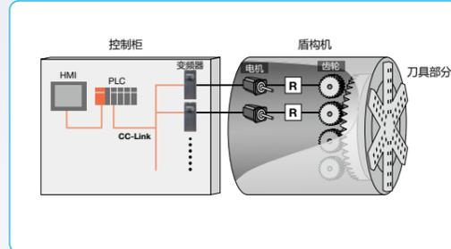
**Point** 变频器可以为挖掘以及挖掘后的土砂搬运作业提供高启动转矩。我们的IP55防护等级产品可供您选择。
