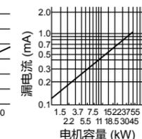
当CV电缆用金属管布线，工频电源运行时每1km的漏电流例
