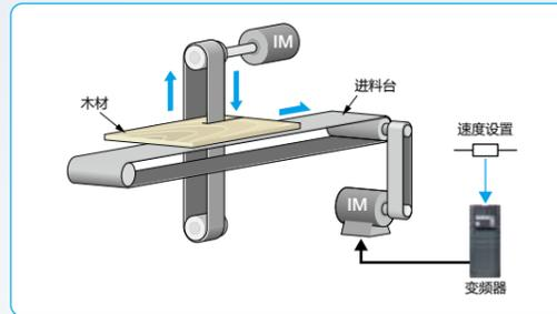
**Point** 即使在加工木材不同硬度部分时，可以最小限度限制速度降低，从而避免加工时间延长。
