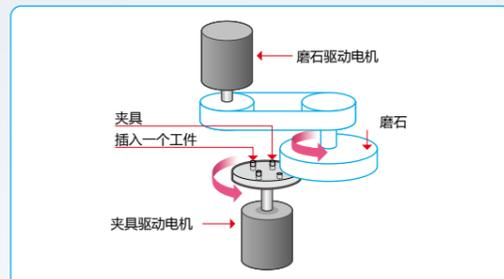
**Point** 转速可根据所加工的材料进行设置。也可采用稳定的高速旋转。
