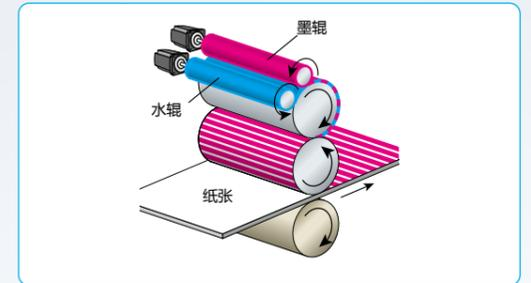
**Point** 高精度的速度控制可最大程度降低颜色不均和打印偏移问题。
