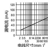
3相感应电机工频电源运行时的漏电流例
