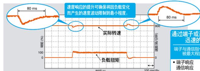
\*2: 在使用通信选项时，通信响应时间为2~5毫秒。速度响应：速度指令发生变化时，显示以多快的速度来追踪变化。（数值越大速度追踪性越快）
