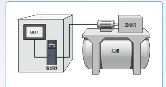
**Point** PM无传感器矢量控制在产生高起动转矩时可发挥作用的同时，还可通过对控制IPM电机，实现节能。
